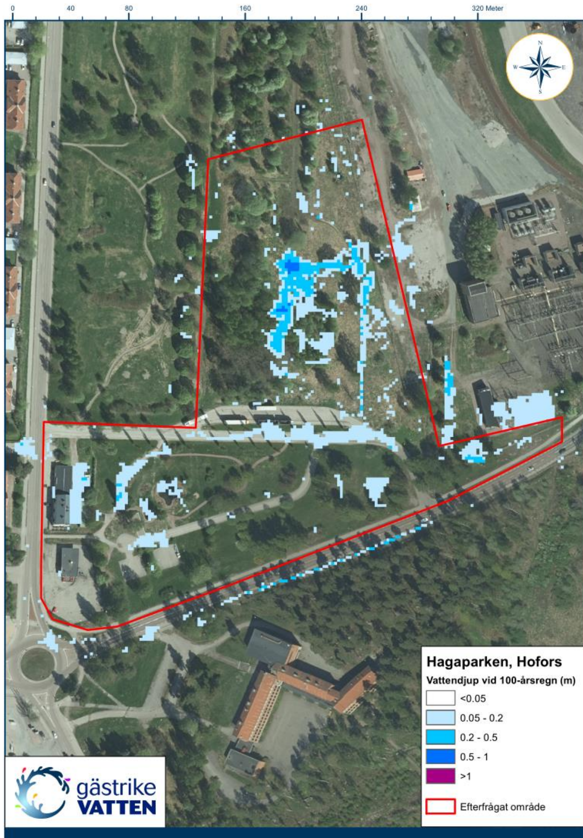
Figur 3. Översvämningsskarta vid 100-årsregn erhållen av Gästrike Vatten. Observera att den endast visar översvämningssområden allra närmast planområdet.
