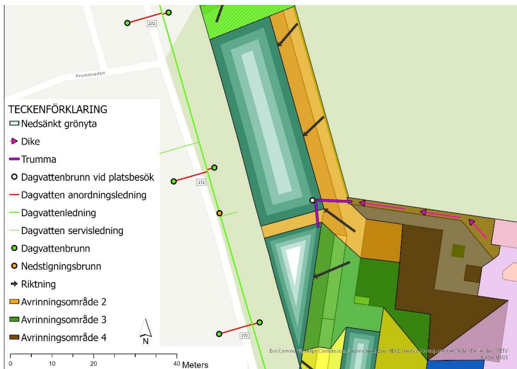
Figur 19. Föreslagen dagvattenhantering och lutning inom avrinningsområde 2, 3 och 4.
