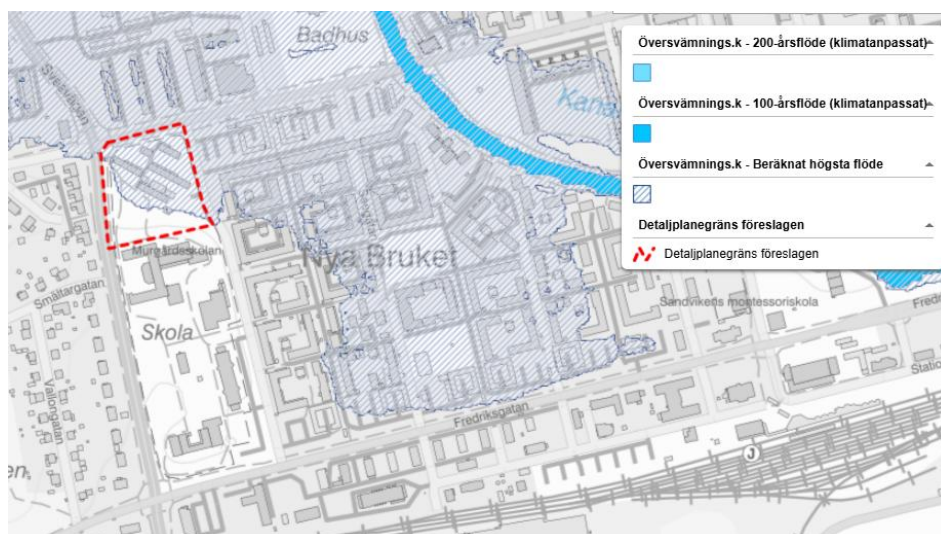
Del av planområdet markerat med blå skrafferas yta omfattas av beräknat högsta flöde från Jädraån.
