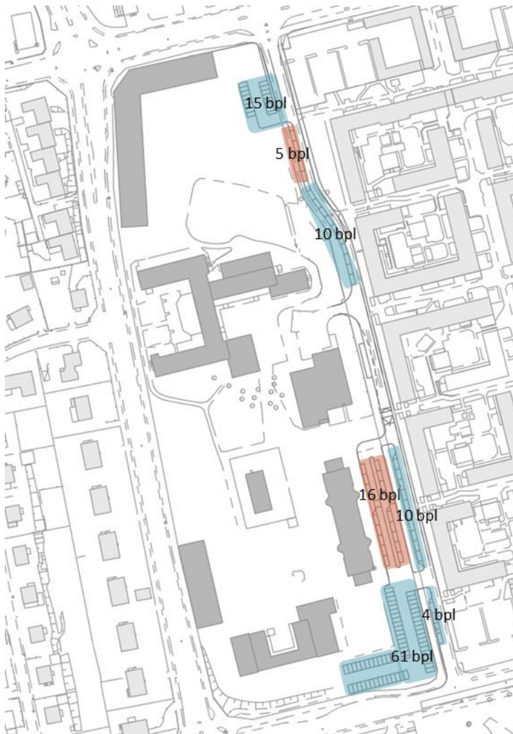
Figur 0-2. Föreslagen utformning av parkeringsytor (100 platser) och ytor för hämta/lämna (21 platser) vid 30 % bilandel. Röda ytor avser hämta-/lämnplatser och blåa avser platser för personal, EPA-traktorer och besökare.
