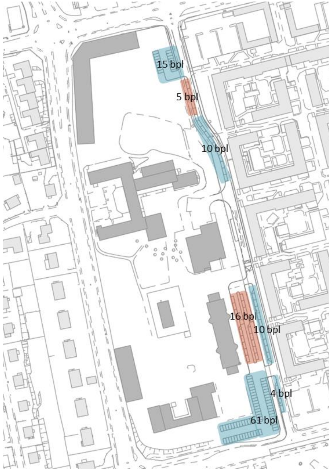
Figur 3-2. Föreslagen utformning av parkeringsytor och ytor för hämta/lämna med scenario 30 % bilandel. Röda ytor avser hämta-och lämnplatser (21 platser) och blåa avser platser för personal, EPA-traktorer samt besökare (100 platser).
