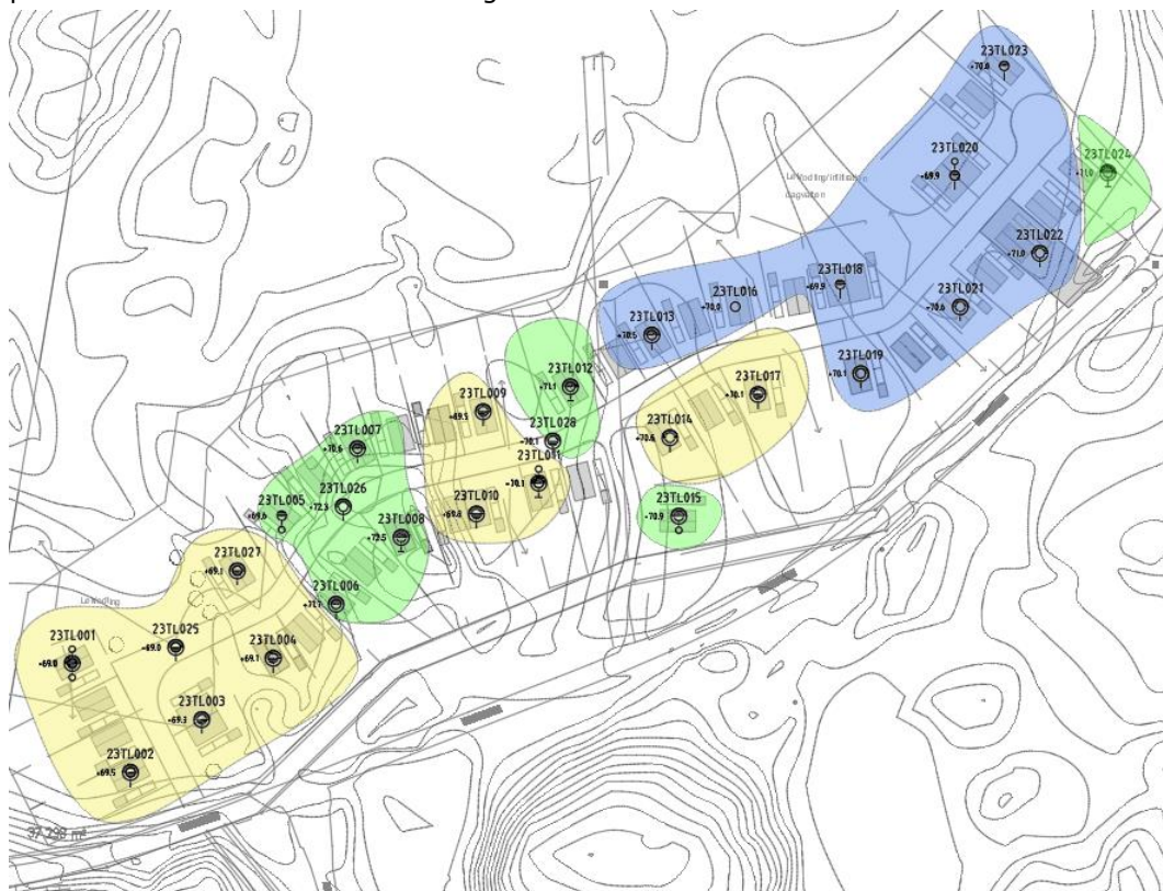
Figur 6.2 – Utförda geotekniska sonderingar och tolkning av dominerande jordarter. Gul markering indikerar siltig lera, grön markering indikerar sand och grus. Blå markering indikerar en grusig sandig morän.
